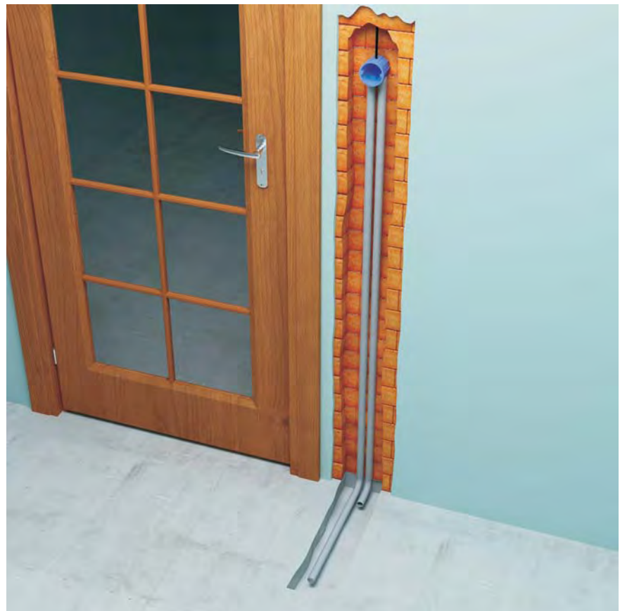
Instalacja rurek ochronnych
